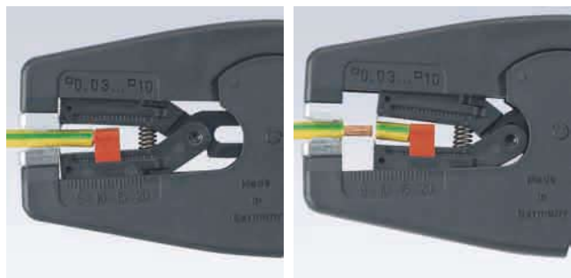
ゲージに突き当てて握るだけでOK 調整いらず!
