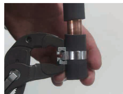
クリック型ホースバンドのつけ外しに
