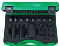
ベアリング挿入工具ミニセット
