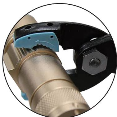
くわえ部に樹脂を使用しているため、プラスチックやステンレス、真鍮、メッキ製品など傷つきやすいものを扱う作業に適しています。
