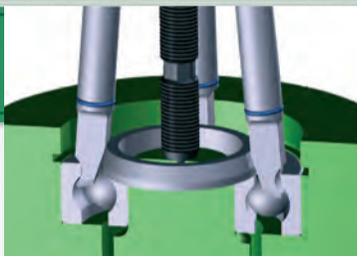
内側から爪を引掛け、溝付きベアリングを傷つけずに引き抜きます
