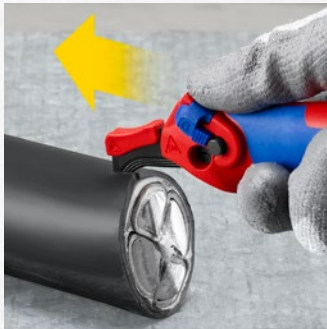
押し込み式または引っ張り式: 縦切り用の2つのブレードセグメント
